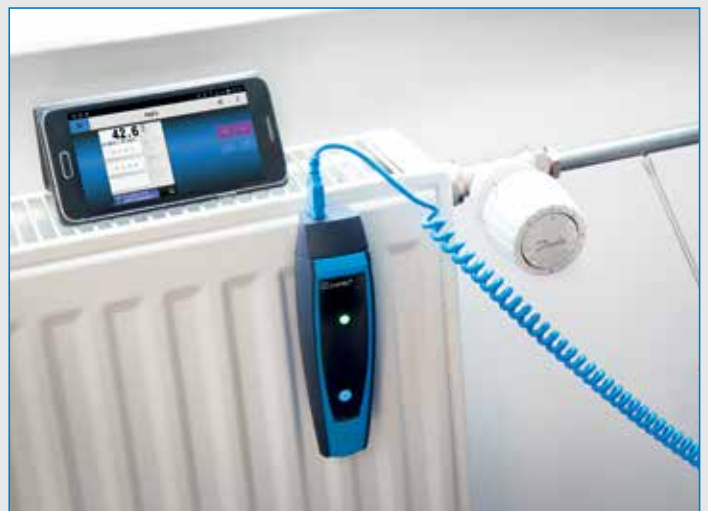
Temperatuurmeting bij een cv-leiding met aflezing met een smartphone met de EuroSoft live app
